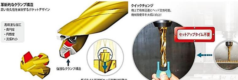
さらに、先端は最新多層PVDコーティング (TT9080) がされているため、耐摩耗性・耐チッピング性に優れ、長い工具寿命を実現するだけでなく、高い切削条件 (高速・高送り加工時) でも安定した加工が可能です。
