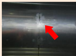
①ロール中央部のクラック補修
