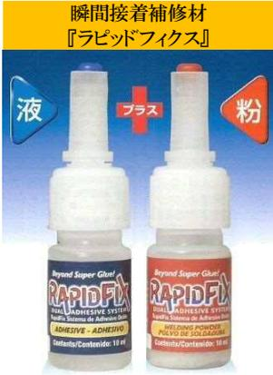
今回は、配管などの緊急補修材としても活用できる瞬間接着補修材『ラピッドフィクス』をご紹介します。当製品は、液体（高分子液体接着剤）と粉末（ウェルディングパウダー）のコンビ使いで使用するのが特徴です。使い方はいたって簡単。まず、穴や亀裂など、補修したい箇所に粉末で埋めます。その後、液体の方を滴下します。これだけです！なお、作業は液体を先につけてもOKです。液体と粉末を混ぜることで、数秒で硬化し
