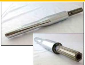
SNGでは、機械部品の受託加工を受け付けております。お客様がご要望される仕様にバッチリ仕上げさせていただきます！今回は、多工程の加工が必要なワークの事例をお届けします。お客様にご依頼いただいたワークはスプライン軸シャフトで、図面の指示上、荒削りからタップ加工、スプライン部加工に加え、硬質クロムメッキにパフ研磨と多工程におよぶ加工が必要なワークでした。一般的に、このような多工程ワークを一社にて完結できる機械設備を有する加工業者はそれほどありません。そこで、SNGがこの多工程ワークの加工を、複数の加工業者の選定から、トータル的な納期管理まで一手に引き受けました！ご依頼されたお客様には、「手離れが良い」と大変ご満足いただけました。お客様のご依頼窓口はSNGだけ！多工程ワークの加工のことならぜひSNGにおまかせください！
