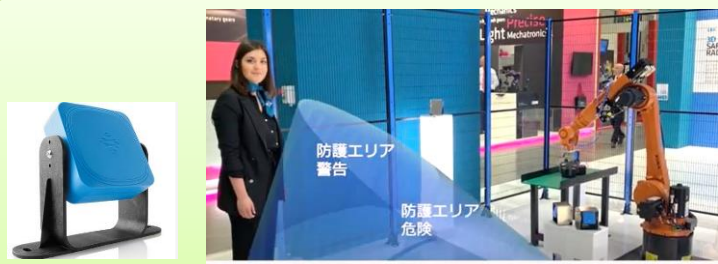
「LBK System」 — 警告エリアへの侵入：ロボットがゆっくりした動きになります。 「検出エリア（イメージ図）」
