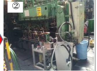
② ポンプにてクエン酸溶液で循環洗浄中
